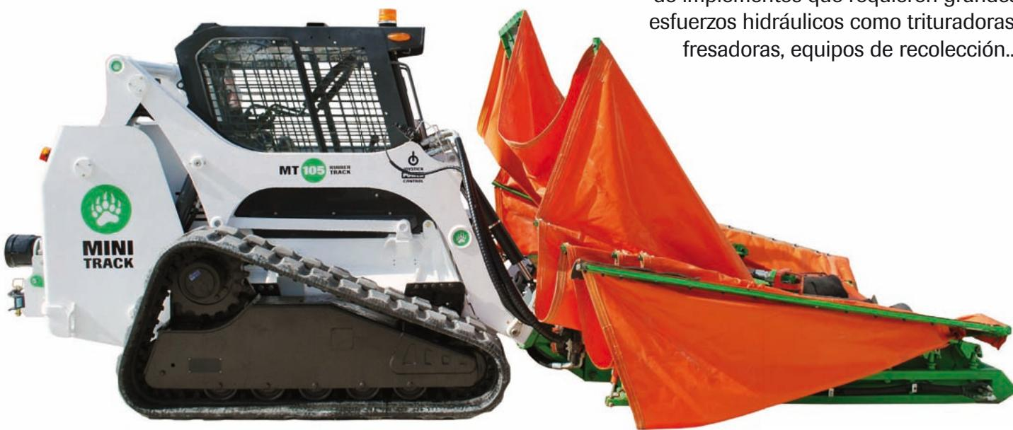
La potencia hidráulica del sistema **Power Flow System MT** dotan a la minicargadora **MT105RT** de la potencia extra que permite el funcionamiento de implementos que requieren grandes esfuerzos hidráulicos como trituradoras, fresadoras, equipos de recolección...
