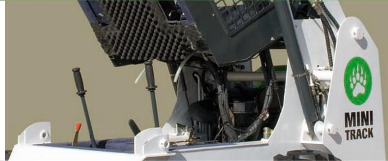
Les bras, construits d'une seule pièce, offrent une résistance élevée aux travaux les plus durs. Sa conception basse permet d'obtenir une visibilité latérale parfaite de la machine. Les Boulons de la chargeuse sont de grand diamètre pour éviter tout jeu éventuel au fil du temps et sont fabriqués en acier de haute qualité.
