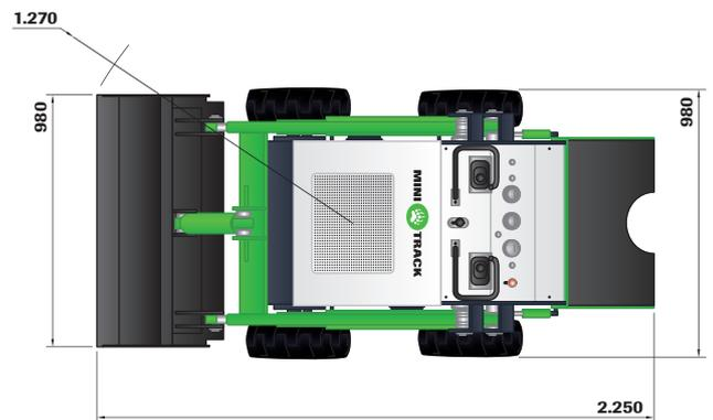
Dimensions en millimètres (mm)
